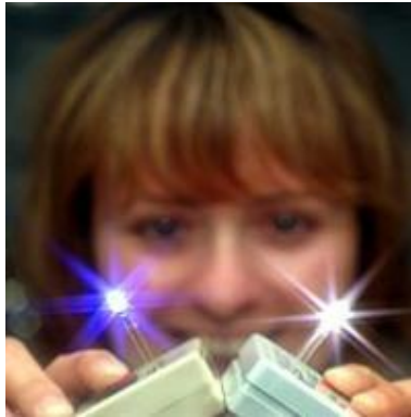
Hình 8: Đèn phát huỳnh quang màu xanh (trái) và màu tím (phải) chế tạo tại Sandia National Laboratories (Mỹ). (Nguồn: http://www.physlink.com/News/071403QuantumDotLED.cfm )
